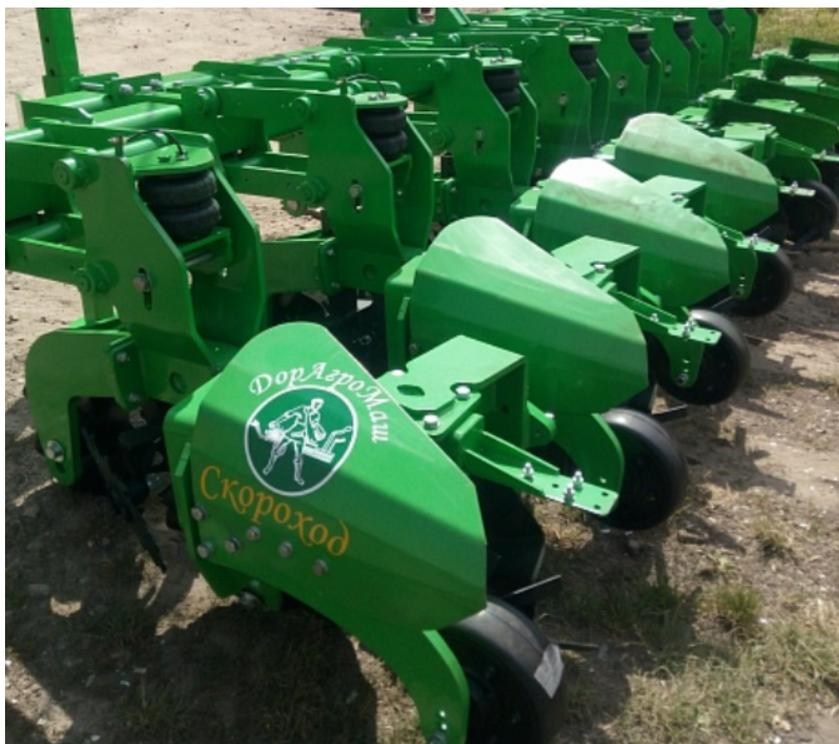
Каждая секция имеет возможность внесения нескольких видов удобрений: гранулированных, КАС.
