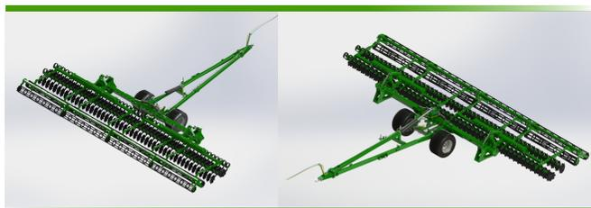
Компактная дисковая борона «Десница» предназначена в равной степени как для поверхностной стерневой обработки почвы, так и для заделки промежуточных культур в легкие и среднетяжелые почвы без забивания. При предпосевной обработке почвы после вспашки, или для посева в мульчированный слой, она оставляет за собой равномерно разрыхленное и выровненное посевное ложе. Тем самым, она по-настоящему универсальна, и позволяет хозяйству снизить затраты и сэкономить драгоценное время.
